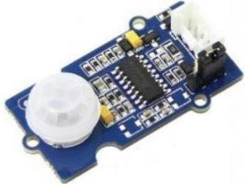
Ce détecteur de mouvement compatible Grove est basé sur un capteur à infrarouges passifs qui détecte les mouvements d'une personne ou d'un animal.
