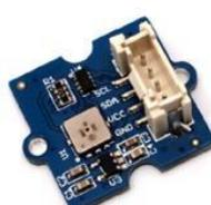
Capteur Baromètre haute précision
