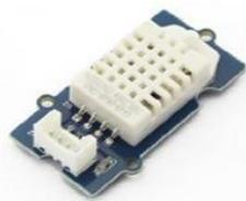
Capteur température et Humidité I2C
